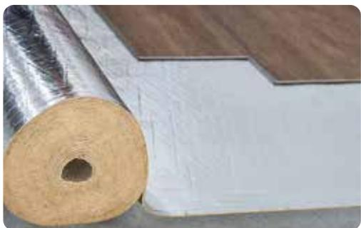
Materassino in schiuma di gomma ad alta assorbenza, accoppiato a lamina con funzione di barriera al vapore. Ideale per uso abitativo con riduzione acustica 22db. Adatto per riscaldamenti a pavimento.
